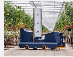
Mobiele robot voor monitoring (frame wordt verhoogd om ook hoog-opgaande groentegewassen in de top te kunnen bemeten).
